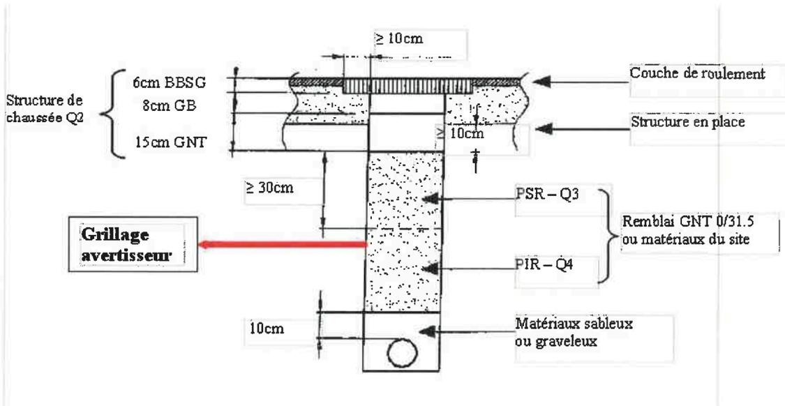
La partie inférieure de remblai (PIR), qui n'existe que dans les tranchées profondes, doit avoir une épaisseur au moins égale à 15 cm, sinon, on l'assimile à la partie supérieure du remblai (PSR). Dans le cas de tranchées étroites ( $\leq 30$  cm), la GNT 0/31,5 du remblai sera remplacée par de la GNT 0/10.
